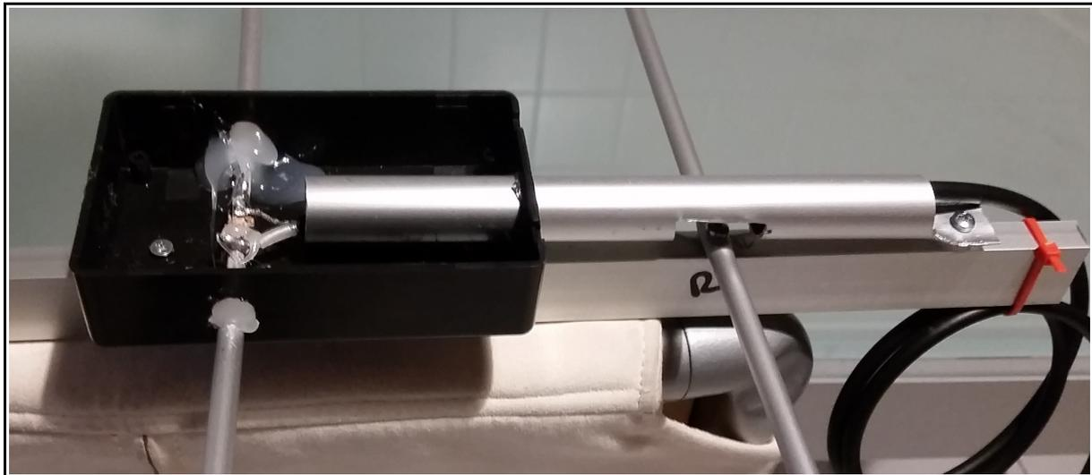
Terminata la parte meccanica , non resta che collegare il cavo coassiale ai capi del dipolo/radiatore e abbiamo finito...
