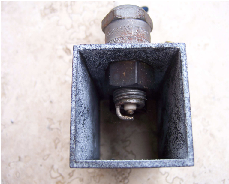
(fig.3) accumulatisi dopo ogni micro scarica. Conviene, comunque, avere sempre una serie di candele pronte all'uso perché in presenza di forti "sberle" di sovratensione, gli elettrodi si fondono: senza se e senza ma!
