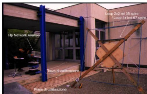
Fig. 3.4.1.2 - Caratterizzazione delle antenne
